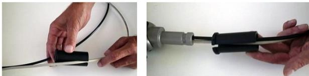
Kabel und Vakuumschlauch durch die Ausfräsung der Kunststoffhülse schieben.
